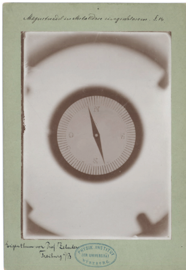
Röntgenfoto door W.C. Röntgen, kompas in dichte metalen doos.
